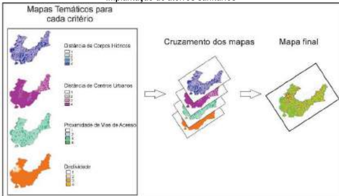
Figura 105: Fluxograma do cruzamento de mapas temáticos para seleção de áreas favoráveis a implantação de aterros sanitários
